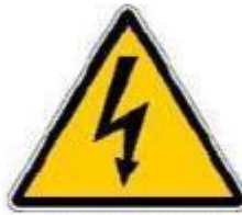
Tensione elettrica pericolosa
