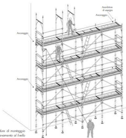
Fig. 3 - Esempio di procedure di montaggio con organo di sollevamento al livello inferiore del piano di assemblaggio
