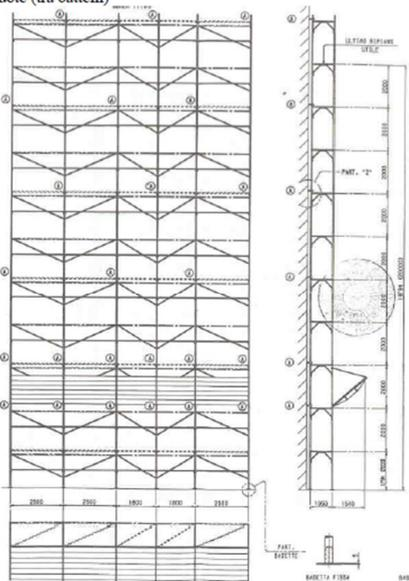
**Ponteggi** strutture provvisorie reticolari multipiani comportano rischi di cedimento improvviso per la loro snellezza
