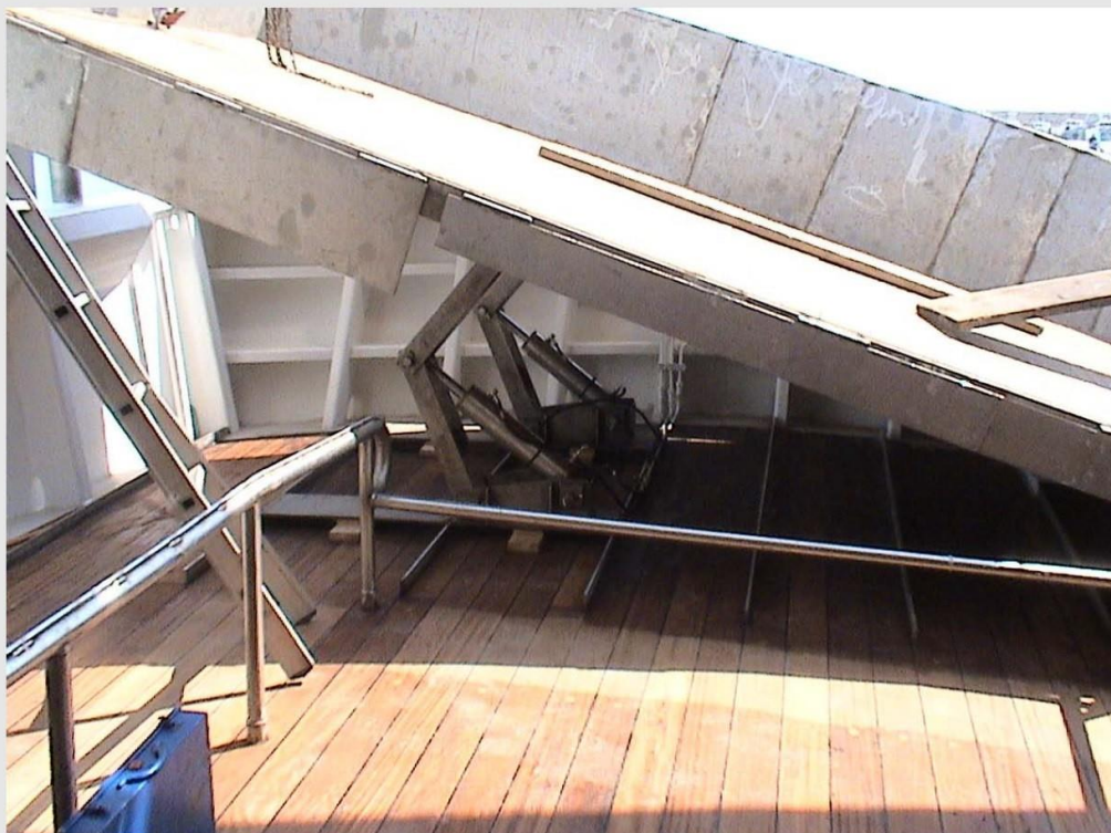
Particolare del piano di poppa rialzabile con meccanismo pneumatico
