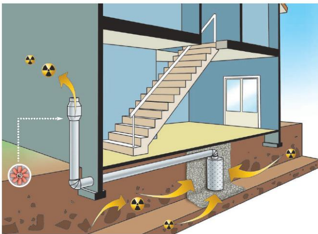
Figura 4.3a. Aspirazione e successiva espulsione dell'aria ricca di radon dopo raccolta tramite pozzetto interrato realizzato centralmente.
