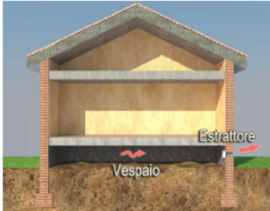
Schema dell'intervento di ventilazione forzata del vespaio.
