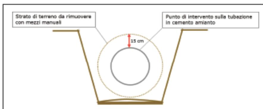
**Figura 3** - Messa a giorno della tubazione idrica in cemento amianto.
